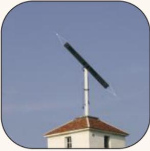
Pour envoyer un signal, mettre le régulateur en position oblique.
